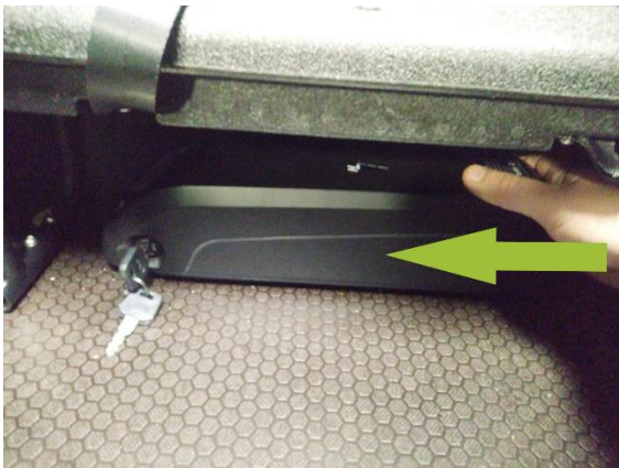
Stap 2: Duw de accu vervolgens een paar centimeter naar links door met uw hand aan de rechterzijde de accu te duwen totdat u een stuk van de slede ziet. Dit mag met enige kracht gaan.
