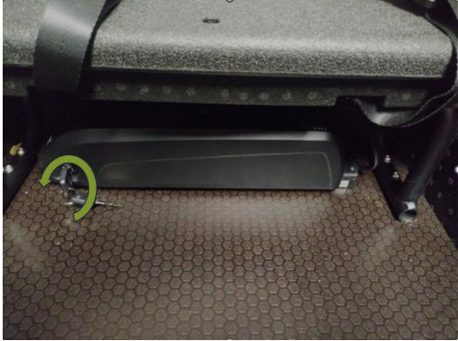
Stap 1: Draai de sleutel tegen de richting van de klok om de accu van het slot te halen
